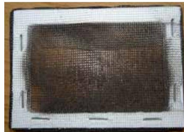
Bei der exemplarischen Messung lag der Druckverlust der verschmutzten Filter 10 % bis 30 % über demjenigen des neuen Filters (was eher unter den Erwartungen lag).
